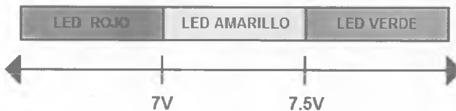
Figura 4.7 - Comportamiento del Medidor de Baterías Digital
