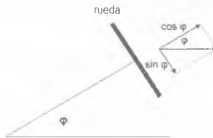
Figura 2.12 - Rotación de la rueda principal y las ruedas periféricas, cuando el robot se mueve sobre el eje x .
