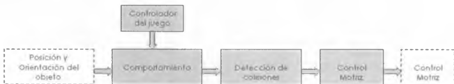
Figura 2.6 - Módulos del Sistema de Inteligencia Artificial
