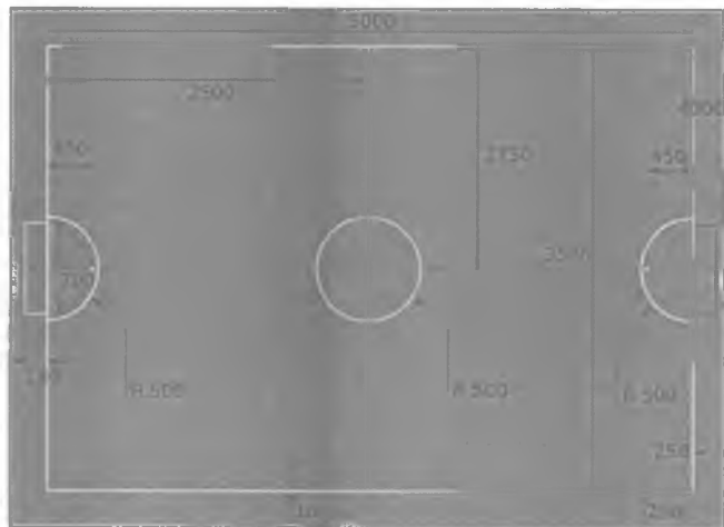
Figura 2.2 - Dimensiones de la cancha de juego para el RoboCup 2007
