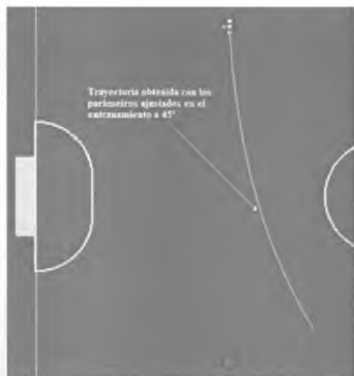
Figura 6.11 - Trayectoria obtenida al mover al robot en un ángulo de 0^\circ con los parámetros ajustados en el entrenamiento a 45^\circ
