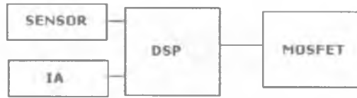
Figura 4.27 - Bloques del circuito de activación de disparo de pelota
