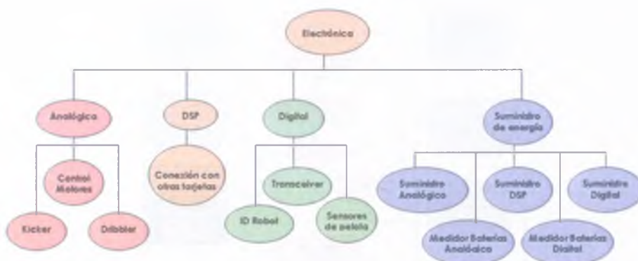
Figura 3.2 - Módulos de la Electrónica de un Robot SSL generación EK2007
