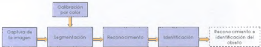
Figura 2.4 - Módulos del Sistema de Visión
