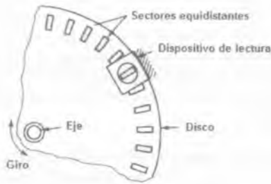
Figura 2.26 - Componentes de un codificador óptico rotacional
