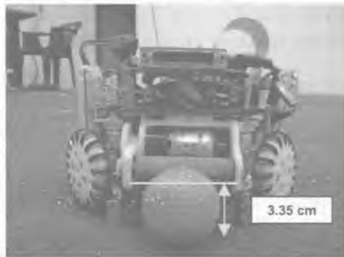
Figura 3.19 Vista frontal del robot con la pelota indicando la altura de la barra.
